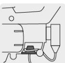
Sujetador de cable para una conexión segura
