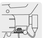
Sujetador de cable para una conexión segura
