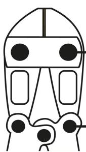
Tornillos de ajuste para mayor precisión y alineación de las cuchillas
