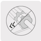
Diseño hexagonal para evitar que ruede
