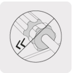
Diseño hexagonal para evitar que ruede
