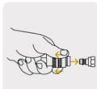
2 Conexiones rápidas de latón, salida 1/4"
