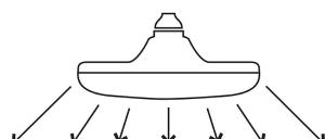
Diseño que permite una difusión amplia de luz de 180°
