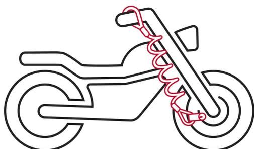
Cable indicador para recordar que está instalado
