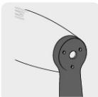
Sistema de sujeción que previene la rotación del mango
