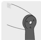
Sistema de sujeción que previene la rotación del mango
