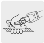
Sujetador de acero con ajuste de longitud
