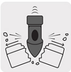
Cara demoledora que dispersa el material hacia los lados
