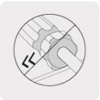
Diseño hexagonal para evitar que ruede
