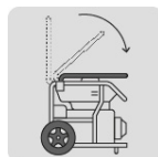
Fácil almacenamiento y transporte con mango abatible y ruedas
