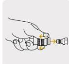
2 Conexiones rápidas de latón, salida 1/4"
