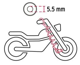
Cable indicador para recordar que está instalado
