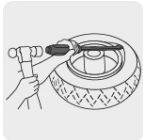
Punta angulada para mayor palanca
