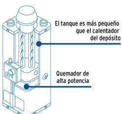
**De paso encendido electrónico**
