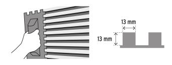
Especial para la aplicación de cementos o adhesivos en la colocación de losetas de gran formato, permitiendo la salida de aire para un mayor agarre y mayor duración.
