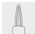
Cautín con punta cubierta de hierro y estaño
