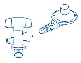
Válvula de servicio con conexión de 7/8" (izquierda)
