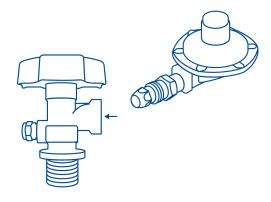
Válvula de servicio con conexión de 7/8" (izquierda)
