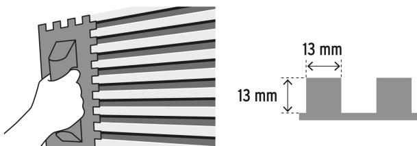
Especial para la aplicación de cementos o adhesivos en la colocación de losetas de gran formato, permitiendo la salida de aire para un mayor agarre y mayor duración.
