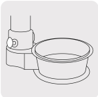
Anillo adaptable para válvulas sin soportes laterales
