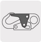
Resistencia de linguete: 3,600 lb (16 kN)
