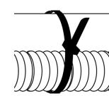
Fijación de tuberías rígidas y flexibles
